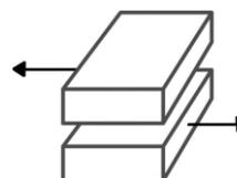
Sistema de dos camas intercambiables. Mientras una se encuentra en la cabina de corte, en la otra se puede realizar la carga o descarga de material.
