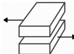
La máquina integra un sistema de dos camas intercambiables que agilizan el proceso de producción. Mientras una cama se encuentra en la cabina de corte, en la otra se puede realizar la carga o descarga de material.
